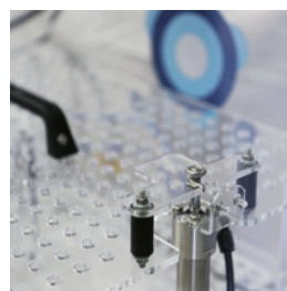
Cestello su cilindro pneumatico per prove di immersione non distruttive
