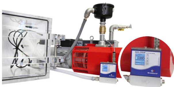
Système complet caisson + pompe/débitmètre pour traitement d'une fuite d'air
